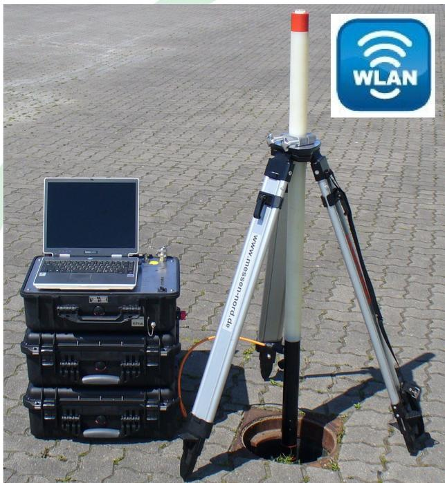
Facile da utilizzare, pratico e robusto, il sistema di collaudo ad aria e ad acqua ROHRTEST si distingue per la sua versatilità, modularità e precisione di misura.
